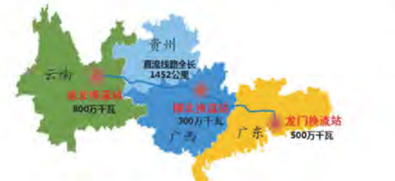
昆柳龙直流工程是落实西电东送战略、推动能源绿色低碳转型发展的世界级输电工程，是世界首个也是电压等级最高、容量最大的特高压多端直流输电工程。创造了世界上电压等级最高、输送容量最大、输电距离最长的柔性直流工程纪录，技术创19项世界第一，连通了装机规模世界第七的乌东德水电站和粤港澳大湾区，额定电压±800千伏，额定输送容量800万千瓦，为大湾区提供大量的清洁能源，促进能源供应和绿色发展。
